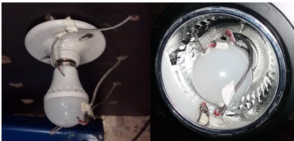
Fotografía 1. Bombilla LED con termopares (izquierda), Luminaria tipo bala con bombilla LED y termopares (Derecha).
